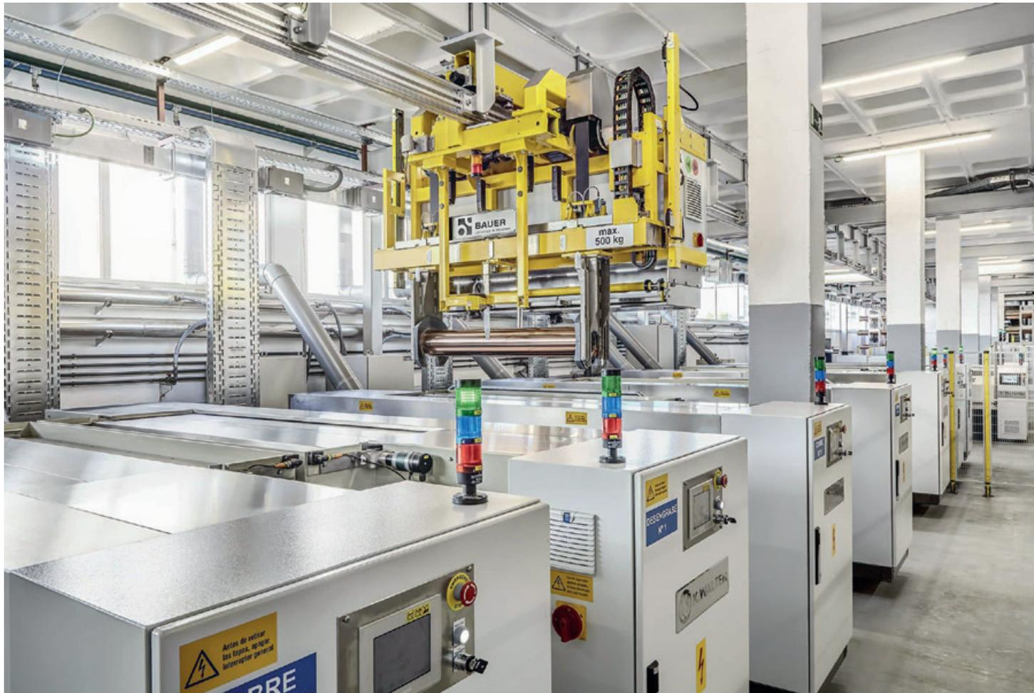
Línea de grabado de cilindros automatizada. / Automated cylinder engraving line.
